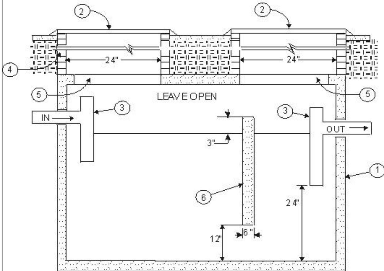
1. PRECAST TANK, \_\_\_\_\_ GALLONS.
