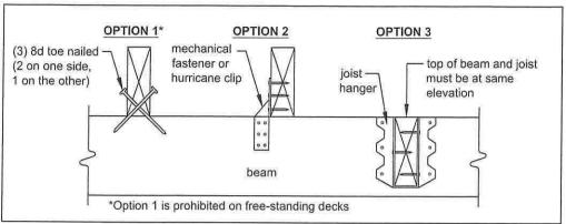
FIGURE 8: JOIST-TO-BEAM DETAIL
