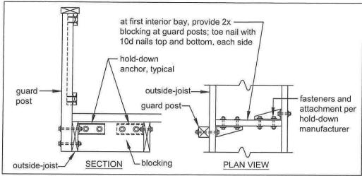
FIGURE 30: GUARD POST-TO-OUTSIDE JOIST DETAIL
