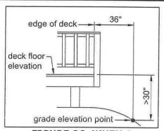
FIGURE 26: WHEN A GUARD IS REQUIRED
