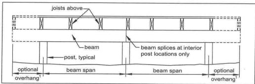
FIGURE 5: BEAM SPAN TYPES
