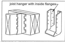
**FIGURE 9: TYPICAL JOIST HANGERS**
